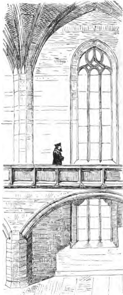
Abbildung 12. St. Wolfgangskirche zu Schneeberg. System der Längswände.
